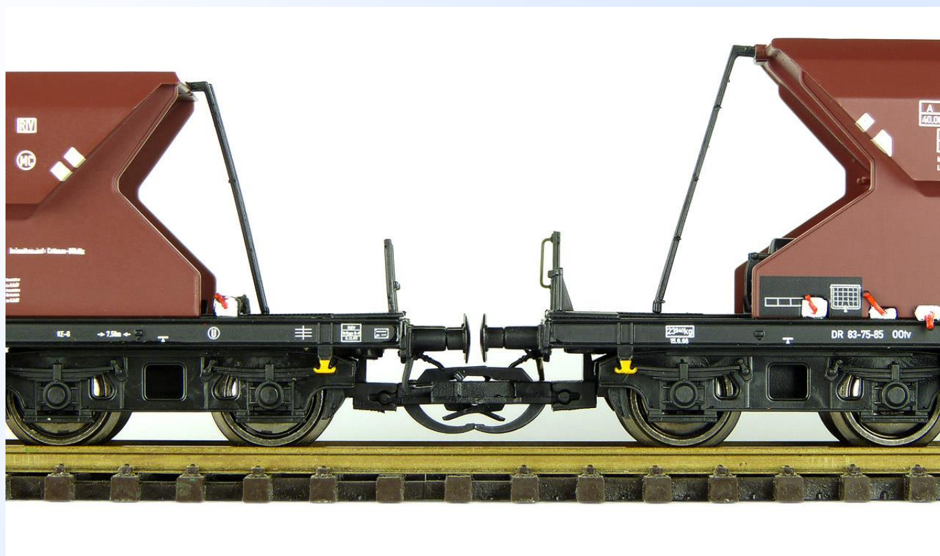
Obr. 9: Vzdálenost mezi nárazníky spojených vozů je cca 0,9 mm.
