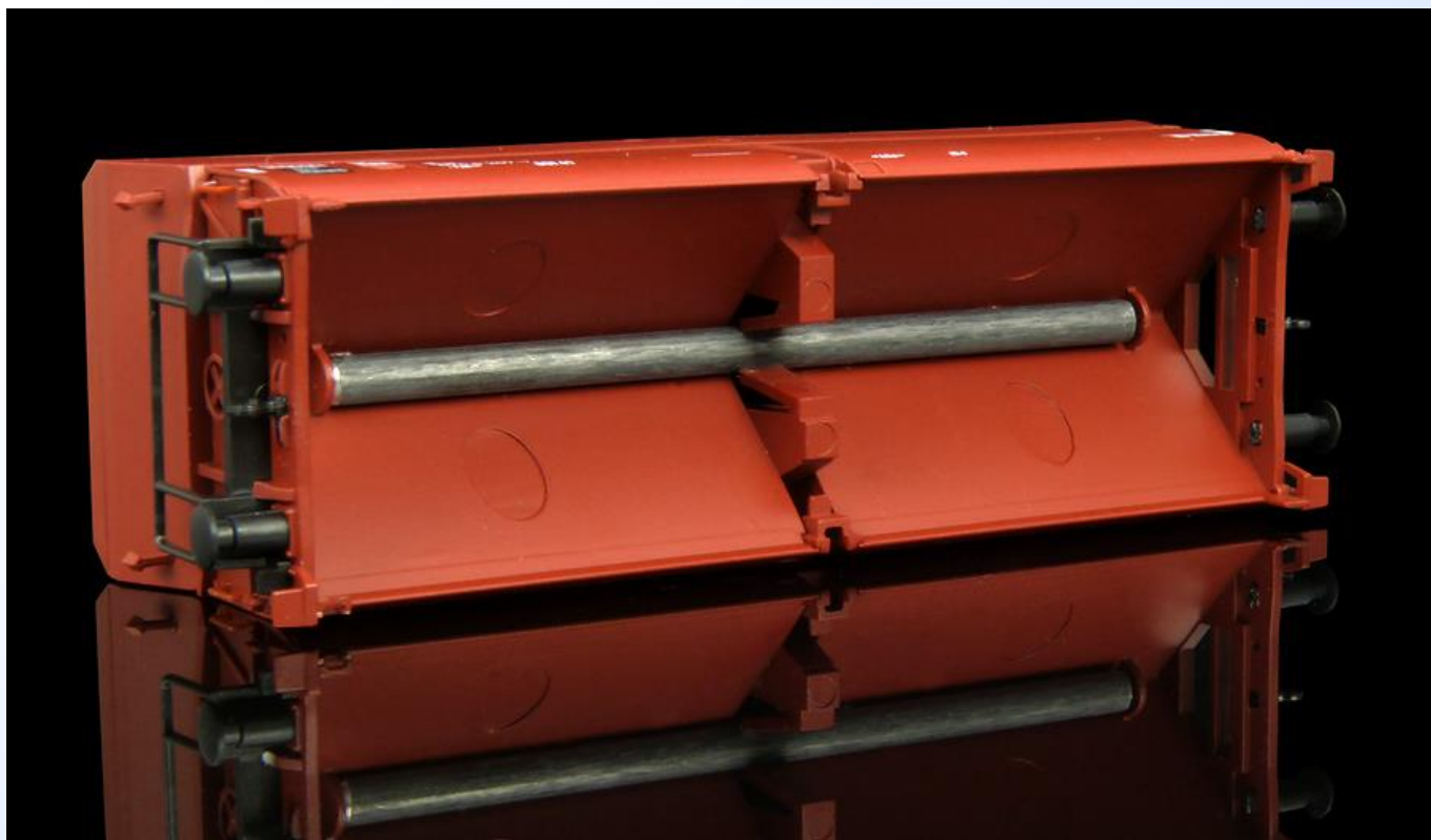
Obr. 4: Spodní pohled na skříň a závaží.
