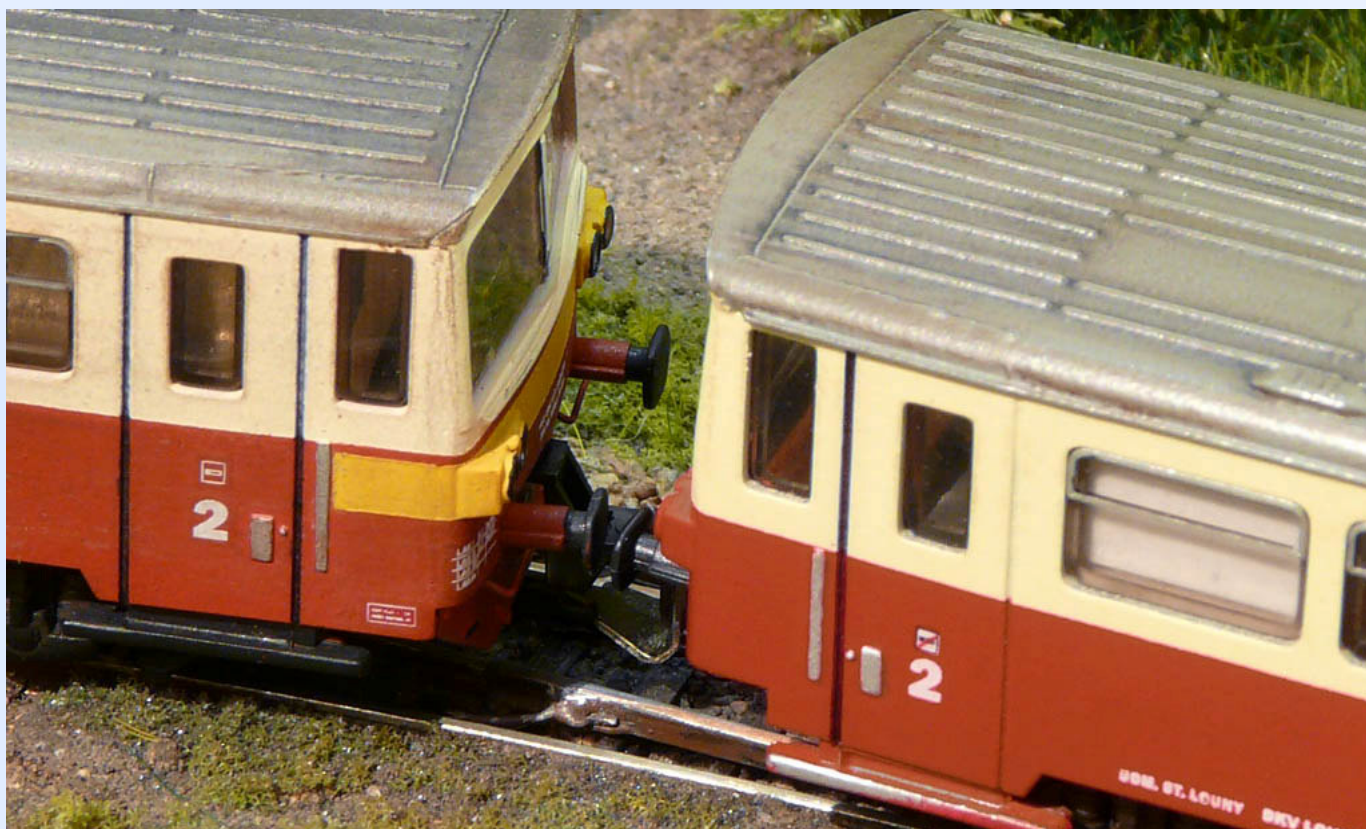
Obr. 8: Spojení stejných vozidel po úpravě – výhybka EW1
