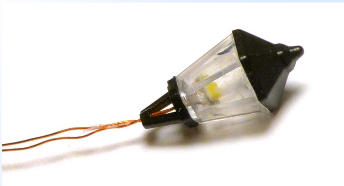
Obr. 2: Po instalaci ledky se na lucernu nalepí kryt a spodní držák.
